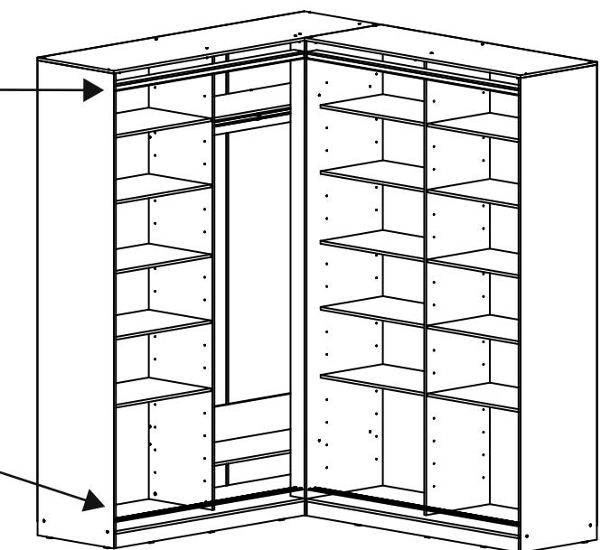
Закрепить верхнюю направляющую саморезами. Верхняя направляющая ставится заподлицо с боковыми стенками шкафа, нижняя направляющая ставится на дно с отступом 18 мм от края.
