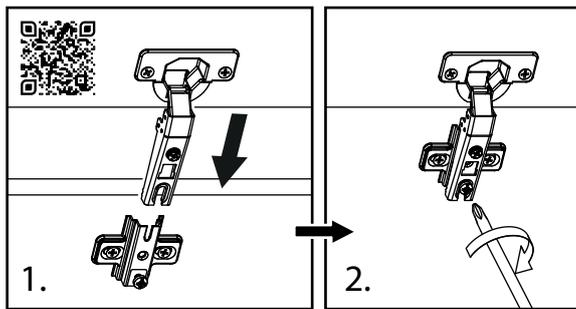
Плечо петли надвигается на ответную планку и фиксируется винтом
